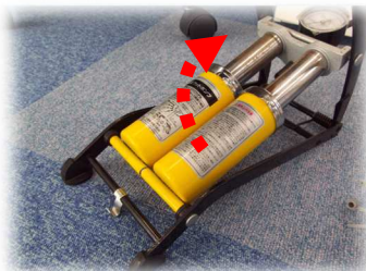
留め金具が外れた状態
