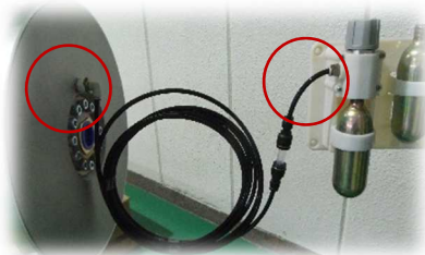
加圧ユニット側エアホースと貯水部の接続 加圧ユニット側エアホース接続 (拡大) 貯水部側エアホース接続 (拡大)
